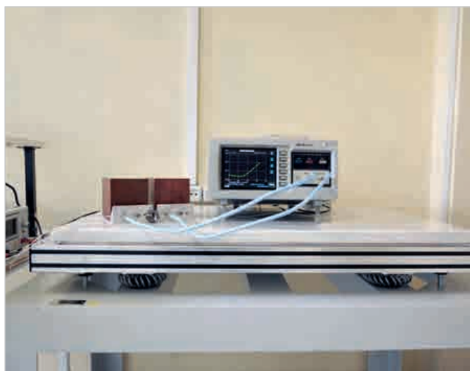
Рис. 8. Внешний вид рабочего места для измерения очень малых величин кратковременной стабильности
